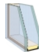
СТЕКЛОПАКЕТ «59» Энергосберегающий (24мм), внешнее закаленное стекло. Заполнен аргоном. R окна – 0,7 м²С/Вт.
